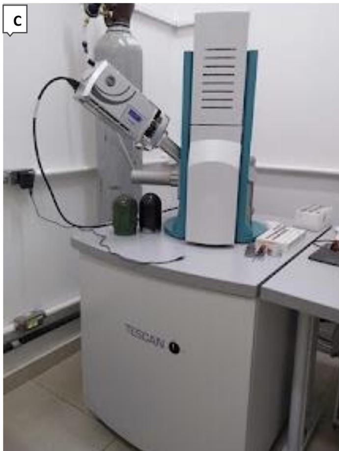
**Figura 14. 14A.** Amostras de cabelo fixadas em stubs com fita dupla face de carbono, dentro da metalizadora. **14B.** Metalizadora Denton Vacuum Desk II utilizada no processo de Sputtering. **14C.** Detector de Energia Dispersiva de Raios-x (EDS), acoplado ao Microscópio Eletrônico de Varredura (MEV).
