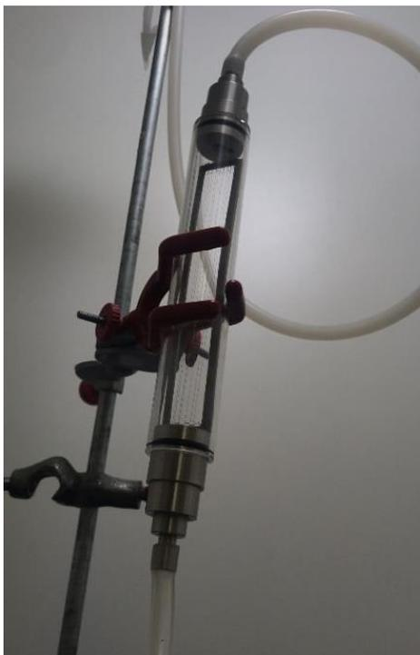
**Figura 11.** Montagem parcial do aparato experimental, evidenciando o a placa de aço inox vazada dentro tubo de vidro acoplado a mangueiras de silicone por meio de dois conectores de aço inox.
